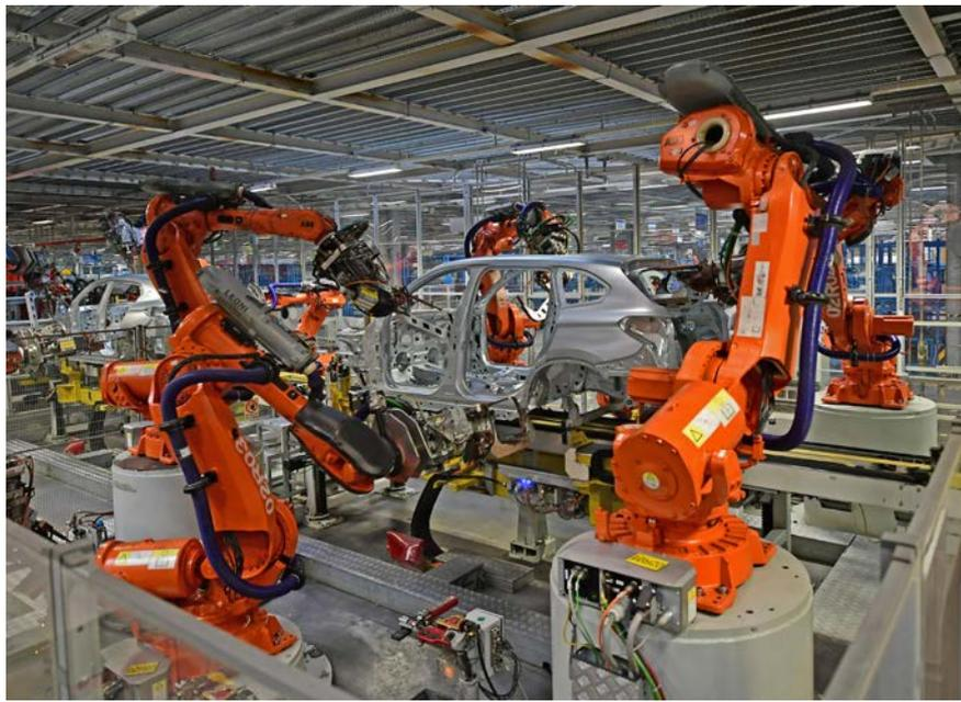
Механические манипуляторы проводят сварочные работы в цехе завода BMW Brilliance Automotive в Тиекси (BBA) в Шэньяне, провинция Ляонин
