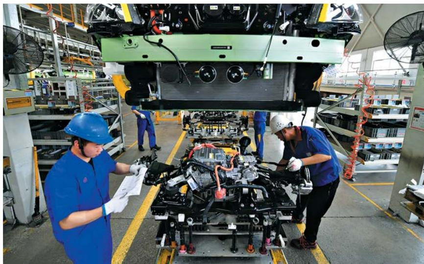
Рабочие устанавливают электродвигатель для нового энергетического автомобиля на заводе компании BYD Auto в Сиане, столице северо-западной китайской провинции Шэньси, 12 июня 2019 г.
